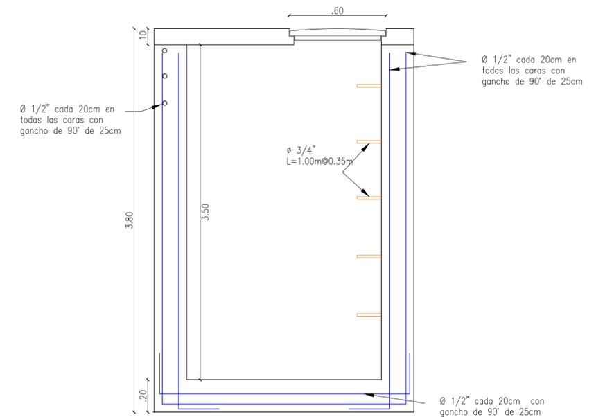
PERFIL REFUERZO PAREDES Y LOSA CÁMARA DE INSPECCIÓN
