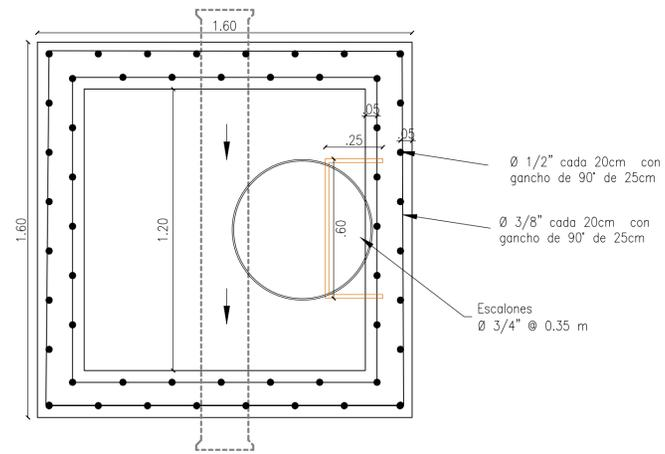
PLANTA REFUERZO PAREDES CÁMARA DE INSPECCIÓN
