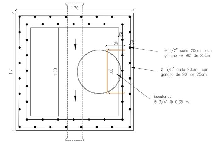
PLANTA REFUERZO PAREDES CÁMARA DE INSPECCIÓN
